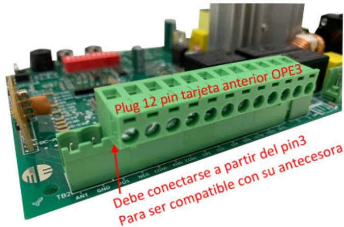
Compatibilidad Tarjeta ME-OPAD con plug hembra de la versión ME-OPE3. Los dos primeros terminales (pin 1-2)) deberán ir con un plug adicional para la conexión de antena
